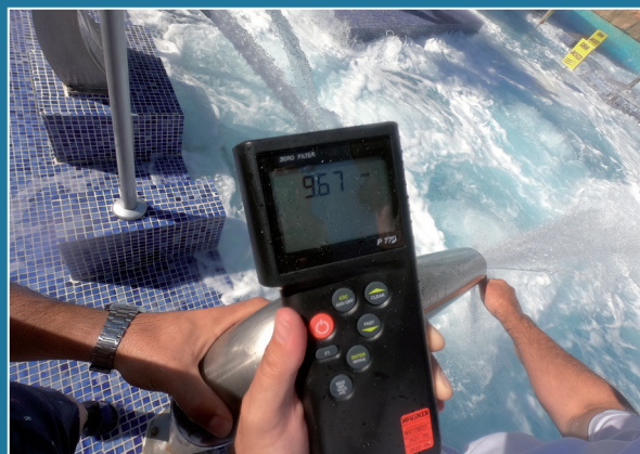
Verificación de la velocidad de impulsión de juegos de agua en zonas wellness.
