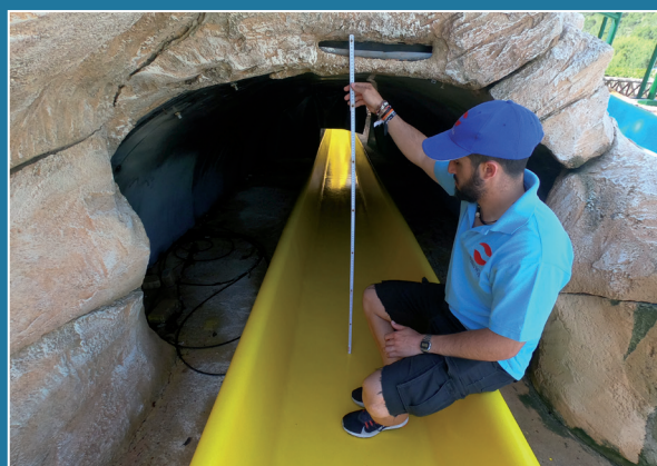
Medición de la zona de seguridad en un tobogán acuático.
